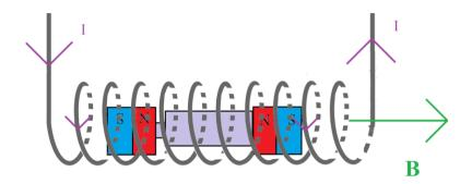
A l'intérieur du solénoïde la pile va faire circuler un courant électrique par l'intermédiaire des aimants, elle va donc devenir un électroaimant. Le champ magnétique ainsi crée ne va pas être uniforme ( on parle de gradient de champ magnétique ), il sera plus intense à certains endroits et moins à d'autres.
